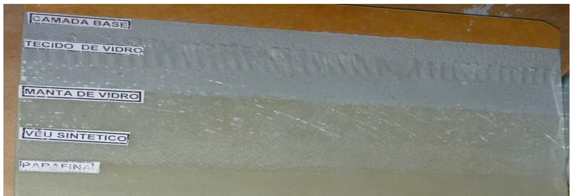
Figura 5 – Sequência de camadas do revestimento
