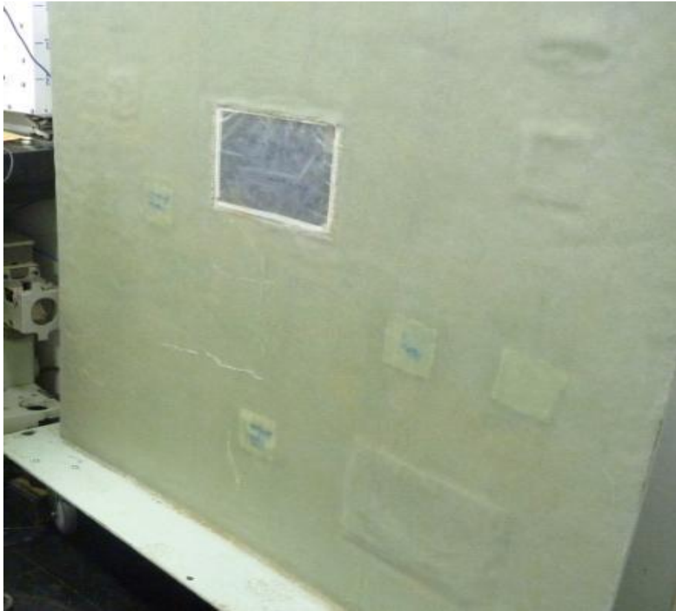
Figura 4 – Corpo de prova com defeitos artificiais
